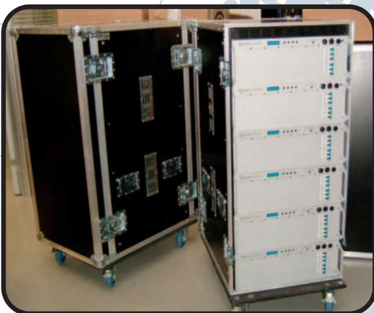
Racks de 25 unidades para DIMMER 26 CH.
