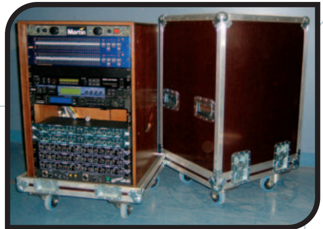
Rack americano con registro trasero. Doble cuerpo independiente.
