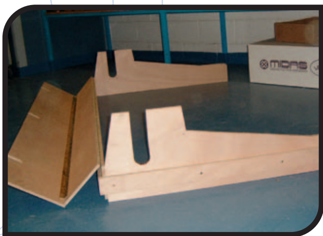
Detalle de cajonera para cableado.
